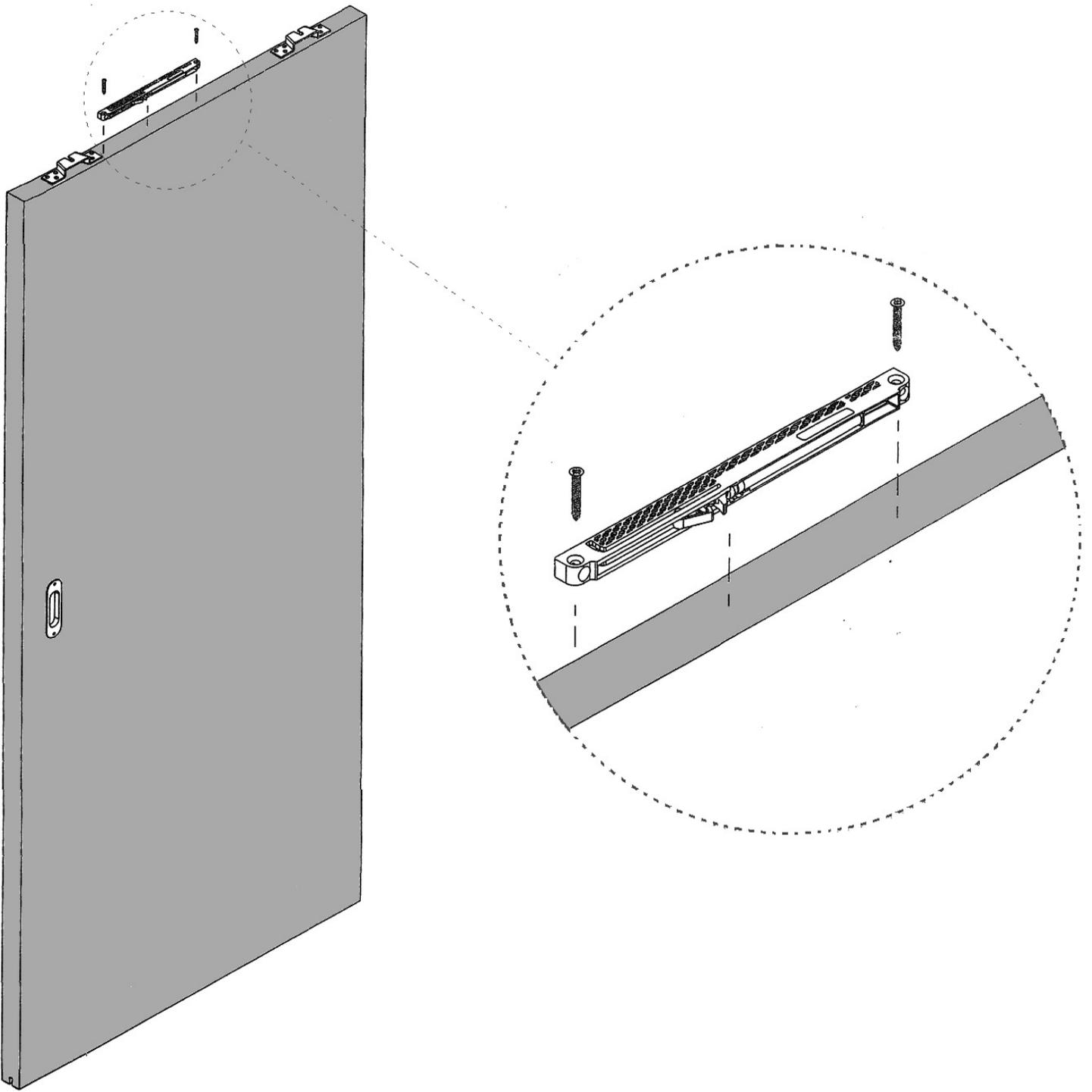
MONTARE IL FRENO SULLA PARTE SUPERIORE DELL'ANTA PRESTANDO ATTENZIONE ALLE QUOTE INDICATE. EVITARE DI FAR SPORGERE TROPPO IL FRENO AL DI FUORI DELL'ANTA PERCHÉ POTREBBE STRISCIARE SUL TRAVERSO. FISSARE IL FRENO CON LE 2 VITI IN DOTAZIONE
