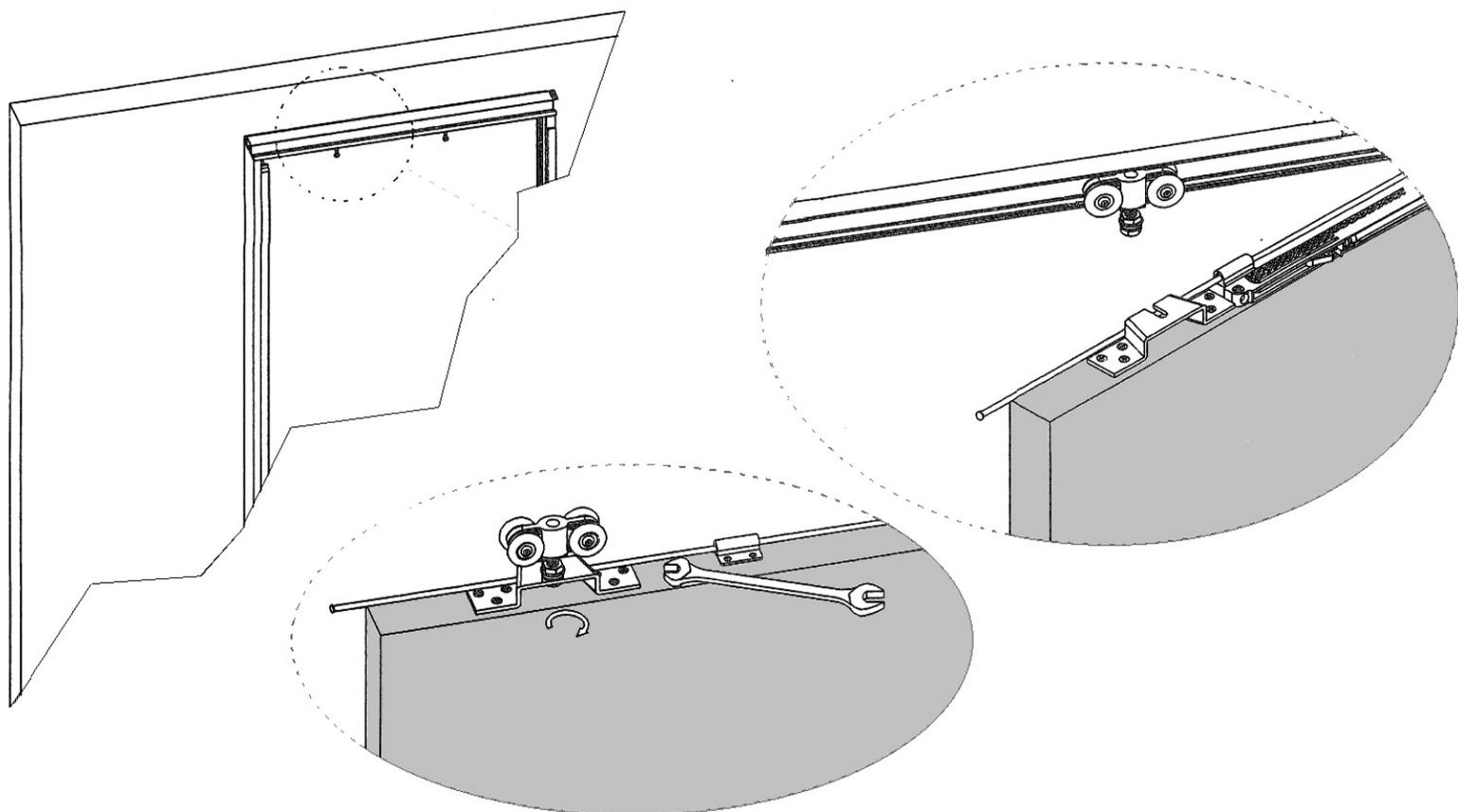
MONTARE L'ANTA SUL CONTROTELAIO
