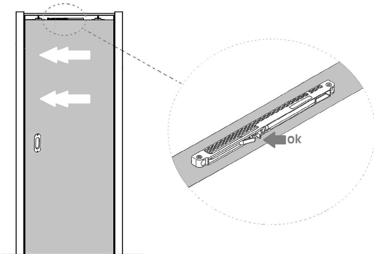
**PORTARE L'ANTA IN BATTUTA. PRECARICARE IL FRENO PRIMA DI DETERMINARE IL PUNTO DI ANCORAGGIO DELL'ATTIVATORE.**
