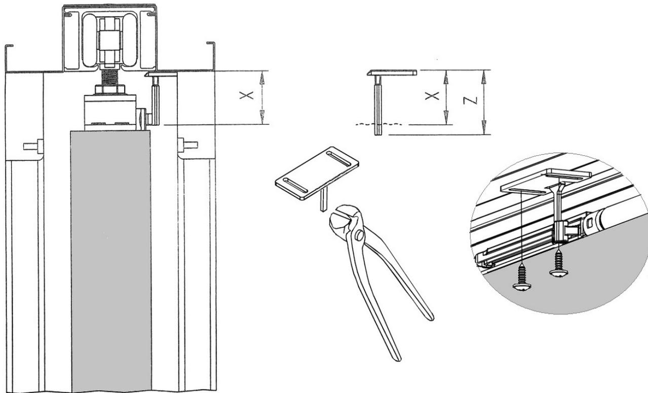
**VERIFICARE CHE L'ATTIVATORE NON INTERFERISCA CON L'ANTA. SE COSI NON FOSSE, ACCORCIARE L'ATTIVATORE FINO AD EVITARE IL CONTATTO TRA LO STESSO E L'ANTA. FISSARE L'ATTIVATORE UTILIZZANDO LE 2 VITI IN DOTAZIONE.**
