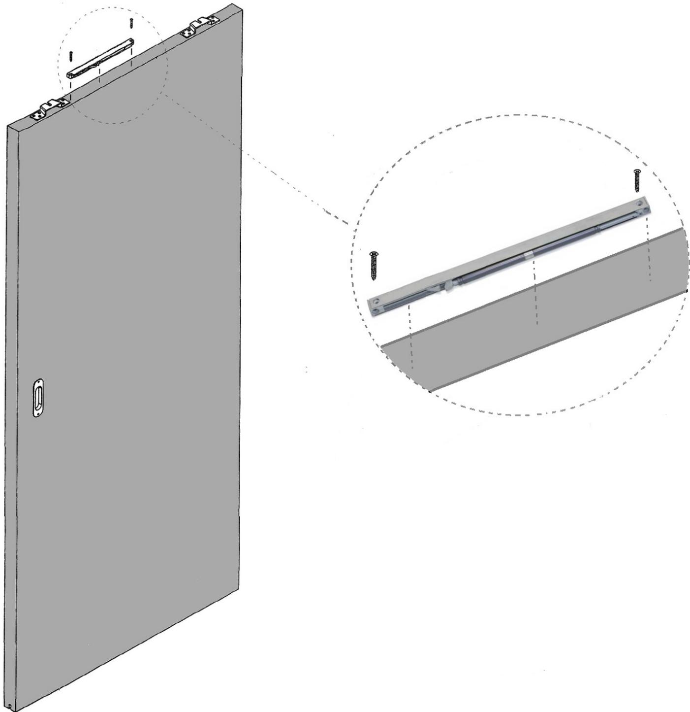
**MONTARE IL FRENO SULLA PARTE SUPERIORE DELL'ANTA PRESTANDO ATTENZIONE ALLE QUOTE INDICATE. EVITARE DI FAR SPORGERE TROPPO IL FRENO AL DI FUORI DELL'ANTA PERCHÉ POTREBBE STRISCIARE SUL TRAVERSO. FISSARE IL FRENO CON LE 2 VITI IN DOTAZIONE**
