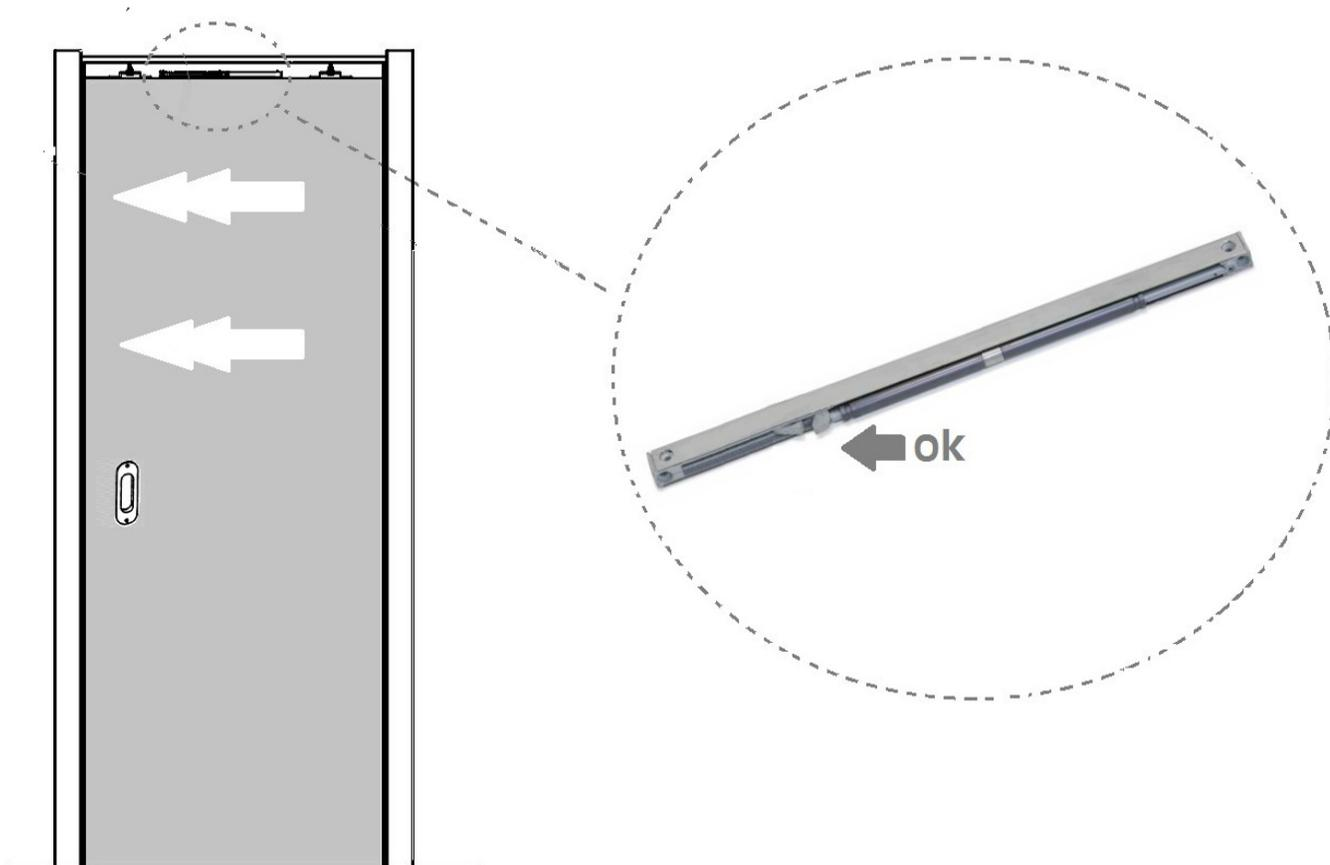
**PORTARE L'ANTA IN BATTUTA. PRECARICARE IL FRENO PRIMA DI DETERMINARE IL PUNTO DI ANCORAGGIO DELL'ATTIVATORE.**
